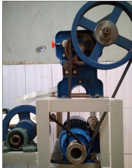
Gambar 2. Mesin pencetak adonan mie
