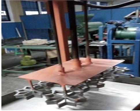
Gambar 3. Profil kembang goyang pada mesin TTG.
