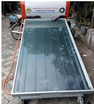
Gambar 2. Pemanas air tenaga surya
