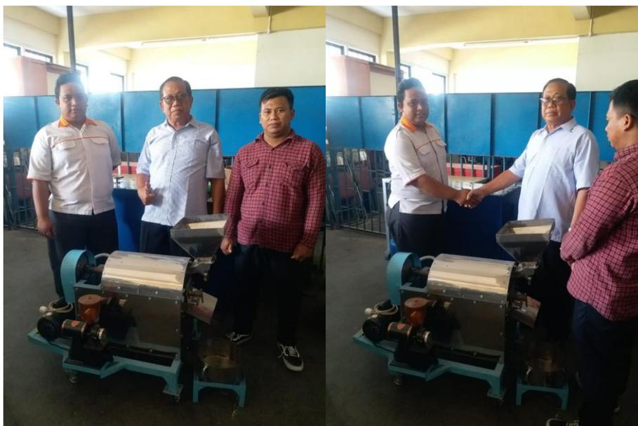
Gambar 1. Penggilingan bumbu pecel kapasitas 5kg/jam
