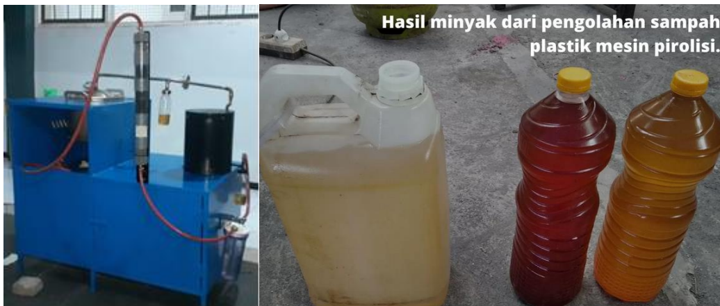
Gambar 2 hasil pirolisis dengan varian bahan plastic
