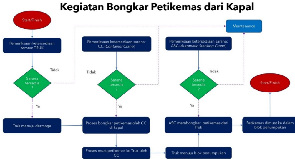
Gambar 3. Operation Process Chart Penanganan Petikemas Dari Kapal
