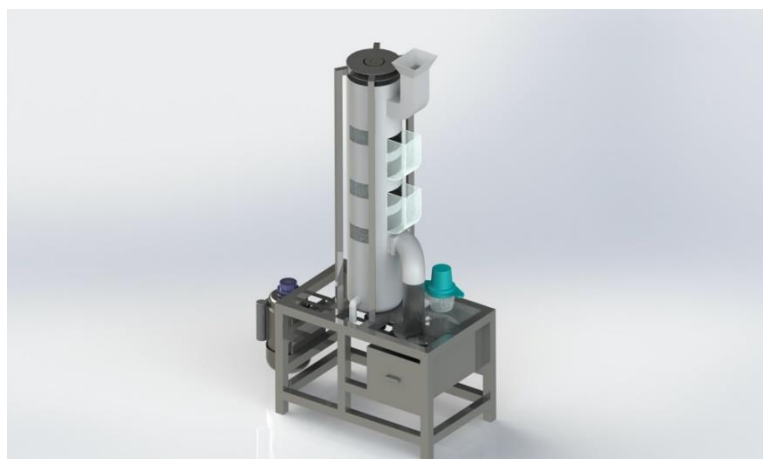
Gambar 2. Desain mesin pengupas pemotong bawang merah portabel
